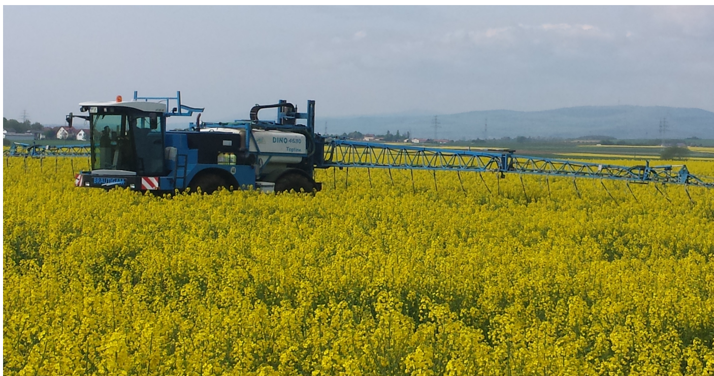
Abb. 1: Einsatz von Drop-Leg Düsen zur Blütenspritzung gegen Sclerotinia.
